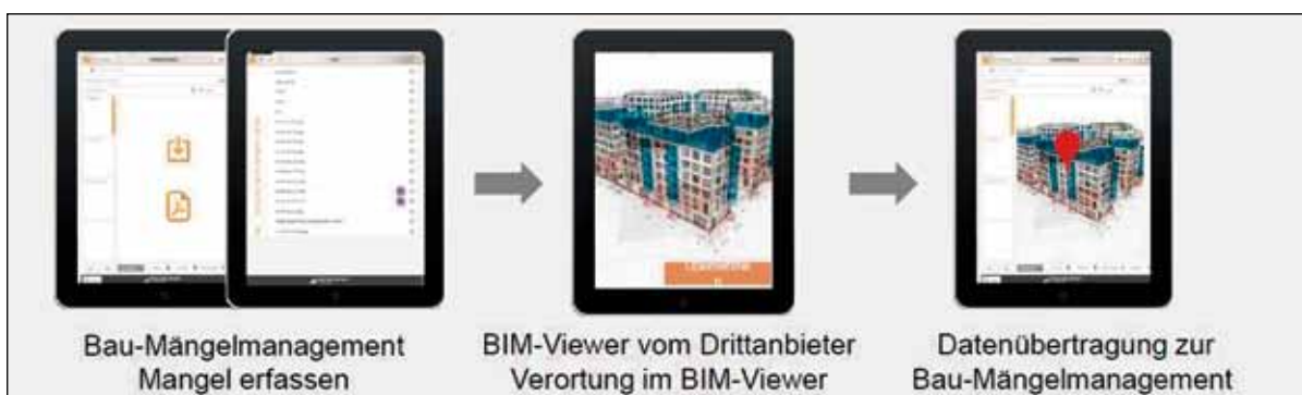
Abb. 2: Mängel in 3D Modell verorten. Die neue Funktionalität wird nicht nur Lücken bei der durchgängigen digitalen Datenübertragung schließen, sondern wird eine neue integrierte Arbeitsweise bei der Erfassung und Verteilung von Informationen aus dem Baubetrieb ermöglichen.
